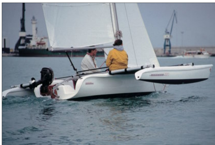
La posición de ambos estabilizadores, por encima de la línea de flotación del casco central, y debiendo apoyar uno de ellos para navegar, nos obliga siempre a mantener ciertos grados de escora.
