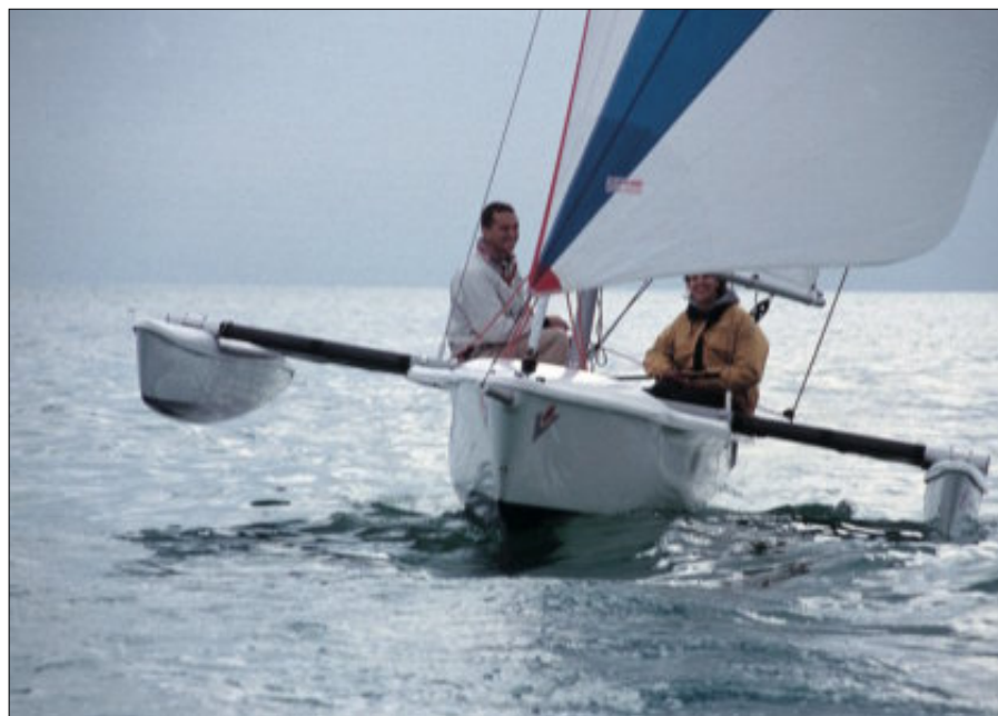
La altura libre de la botavara permite al tripulante trabajar la escota del spi asimétrico, mirándolo por sotavento de la mayor cómodamente.
